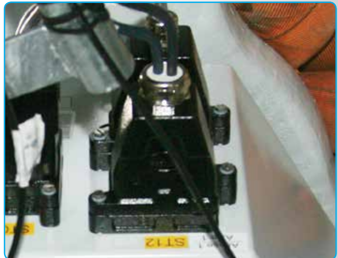
Via de compacte meervoudige UNI-kabelwartels kunnen meerdere kabels op een ruimtebesparende manier worden doorgevoerd (stuureenheid in de rotornaaf)
