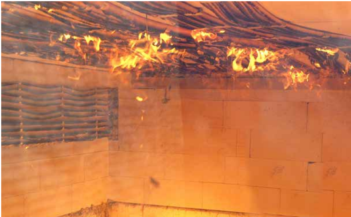
De JMV functiebehoud-systeemtest, E90 tot 1000° C.
