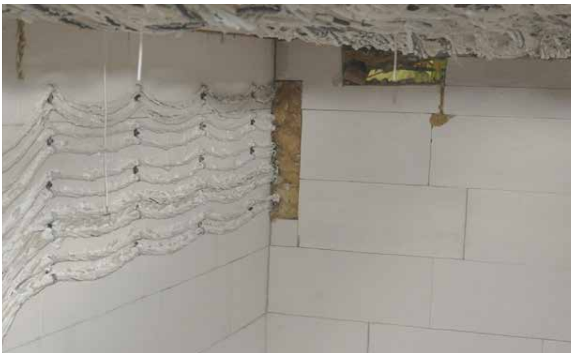
Het eindresultaat na 90 minuten functiebehoud-systeemtesten.
