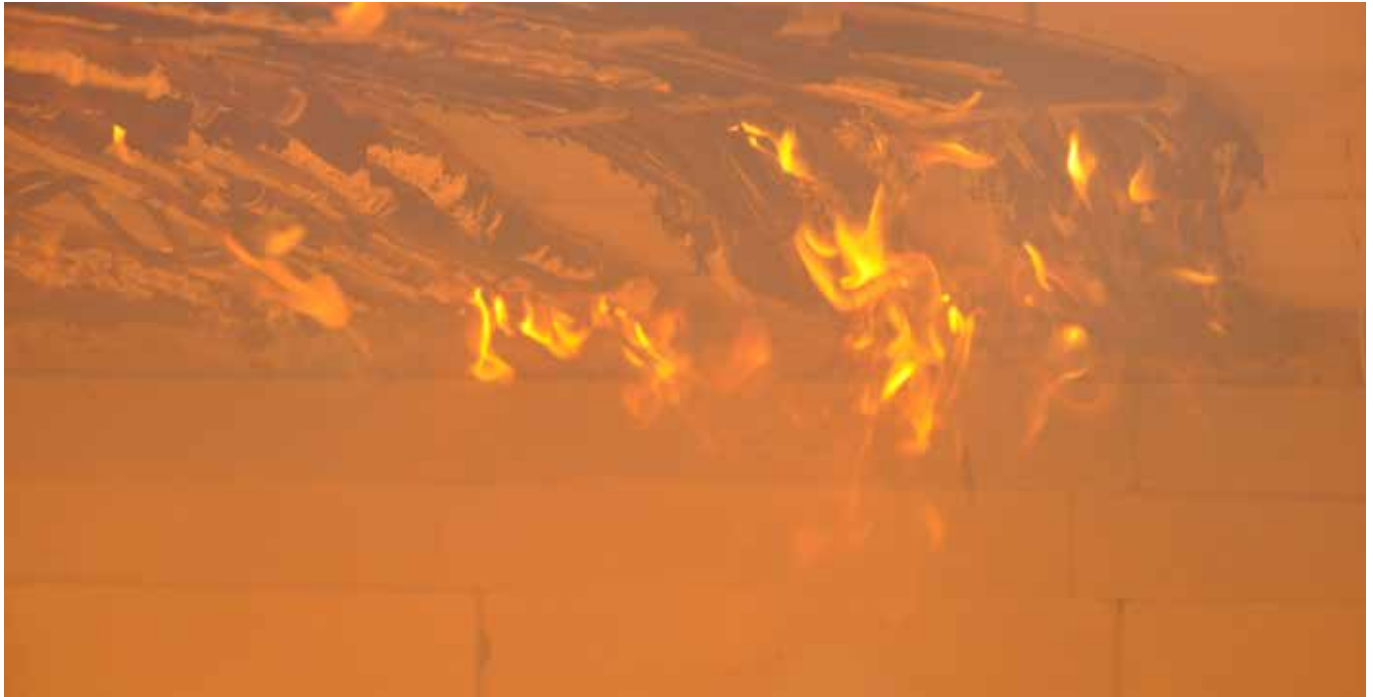
Functiebehoud systeem getest volgens DIN 4102 - 12
